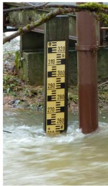
Circa 50 Pegelanlagen betreut das WWA Hof. An jeder Anlage wird der Wasserstand gemessen. Außer an den Seepegeln wird überall der Abfluss ermittelt. An einigen wird zusätzlich die Temperatur und an zwei Pegeln werden Schwebstoffe gemessen.
