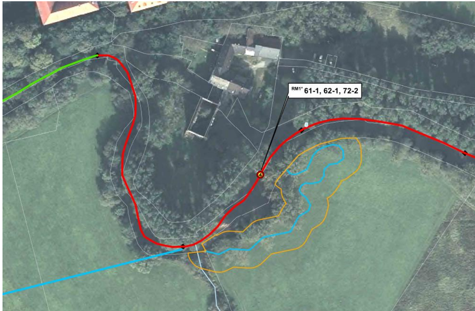
Abbildung 6: Prinzipskizze für die Anlage eines neuen naturnahen Gewässerlaufs als Umgehungsgerinne (blaue Linien) am Roten Main zur Wiederherstellung der Durchgängigkeit (RM1*), der Vorschlag zum Flächenerwerb von je 10 m Uferstreifen beidseitig ist in orange dargestellt
