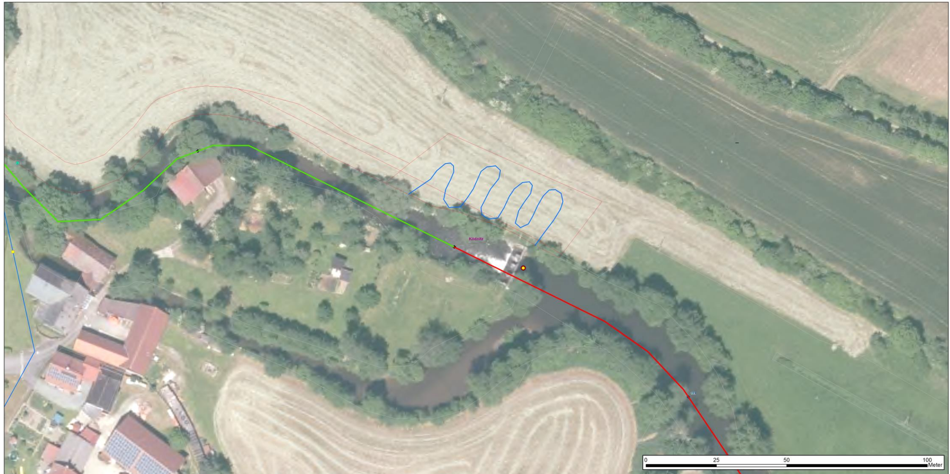
Abbildung 7: Prinzipskizze für die Anlage eines Umgehungsgerinnes (blaue Linien) bei Ködnitz.
