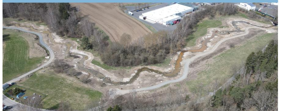
Selb 2021 - Links: der Absturz vor dem Umbau; rechts: die „raue Rampe“ ermöglicht jetzt die Durchgängigkeit für Tiere (Fotos WWA Hof)
