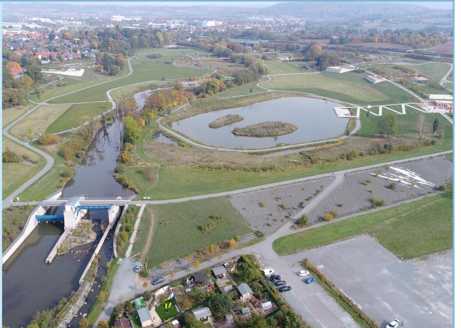
Hochwasserschutz in Coburg: Hochwasser aus Itz, Lauter und Sulzbach haben immer wieder zu Schäden in Coburg, zuletzt 2003, geführt. Ein System aus mehreren Rückhaltebecken schützt die Stadt (Bild links unten). Die größten sind Froschgrundsee an der Itz (Links oben) und Goldbergsee mit Lauterüberleitung (Rechts oben). (Fotos WWA Kronach)
