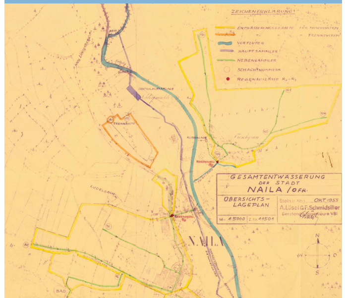
Ein Ausschnitt aus dem Generalentwässerungsplan von Naila mit Kläranlagen, Trennsystem und Mischsystem aus dem Jahre 1955.
