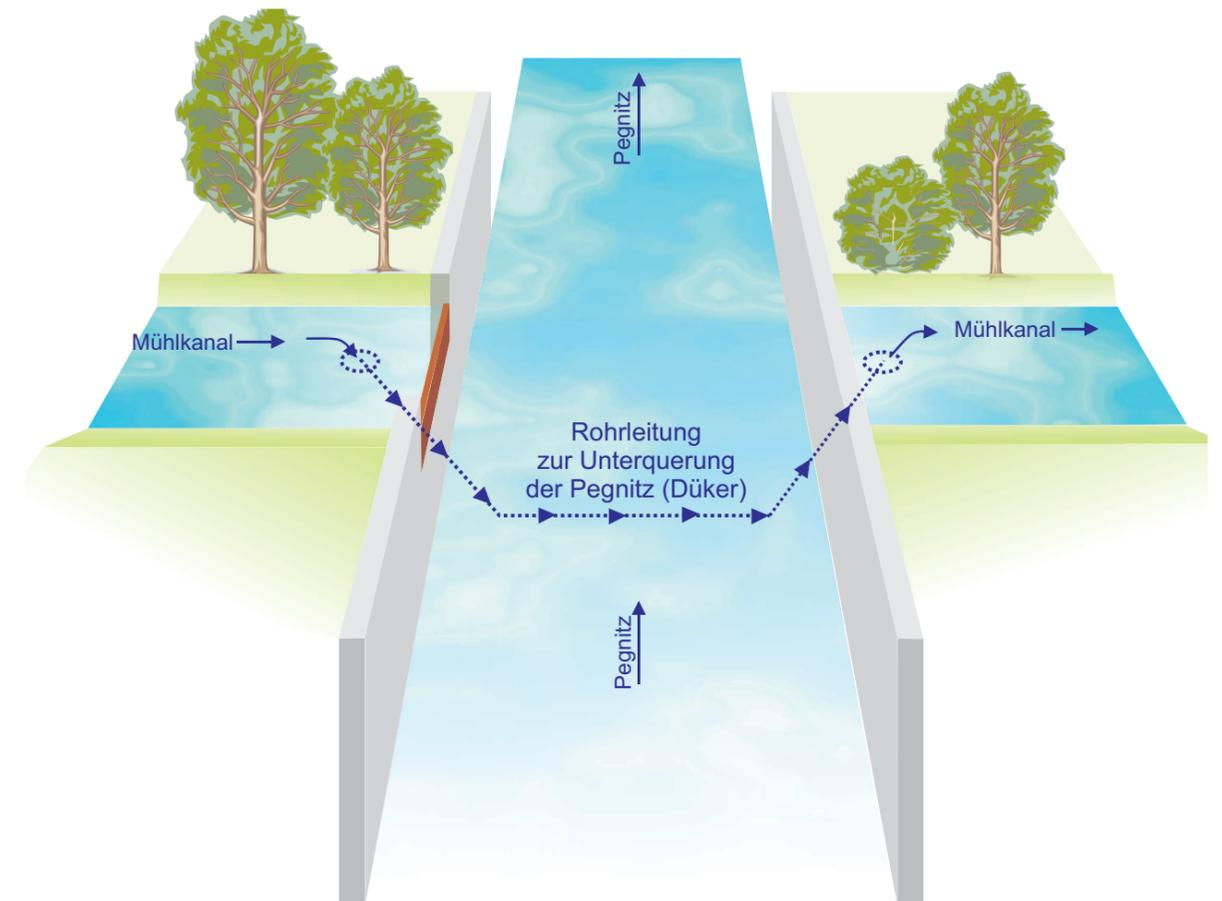
Die Dükerrohre behindern jedoch durch ihren begrenzten Dükerquerschnitt den Abfluss des Fließgewässers. Dies führt zu einem Aufstau der Oberwasserstände (hier: linker Arm der Fichtenohe) gegenüber den Unterwasserständen (hier: Mühlbach). Zur Überwindung der Rohrwiderstände ist der Wasserüberdruck, der sich durch den Aufstau ergibt, notwendig.
