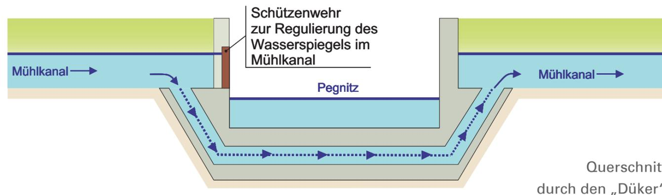
Der Düker arbeitet nach dem Prinzip der kommunizierenden Röhren d.h. der Wasserstand ist auf der linken Mühlbachseite genauso hoch wie auf der rechten Seite.
