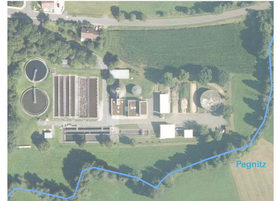
Überschüssiger Schlamm sowie der Schlamm aus der Vorklärung werden dem Faulturm zugeführt. Das entstehende Methangas dient zum Heizen und mithilfe eines Blockheizkraftwerkes der Stromerzeugung. Nährstoffreiches Prozesswasser aus der Schlammendickung und -entwässerung kann zwischengespeichert und wieder zudosiert werden. Ausgefaulter Schlamm wird mit entwässert und an ein Kompostierwerk geliefert.
